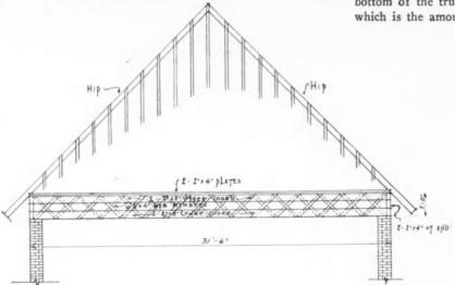
· DECTION · AT · FRONT · SHOWING · TRUSS · "A"
