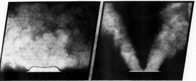
HONEYWELL REGISTER FACTORY SETTING-120° FACTORY SETTING-22°-22°
