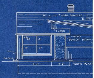
• FRONT ELEVATION - ALTERNA SCALE : 1/8"=1'-0"
