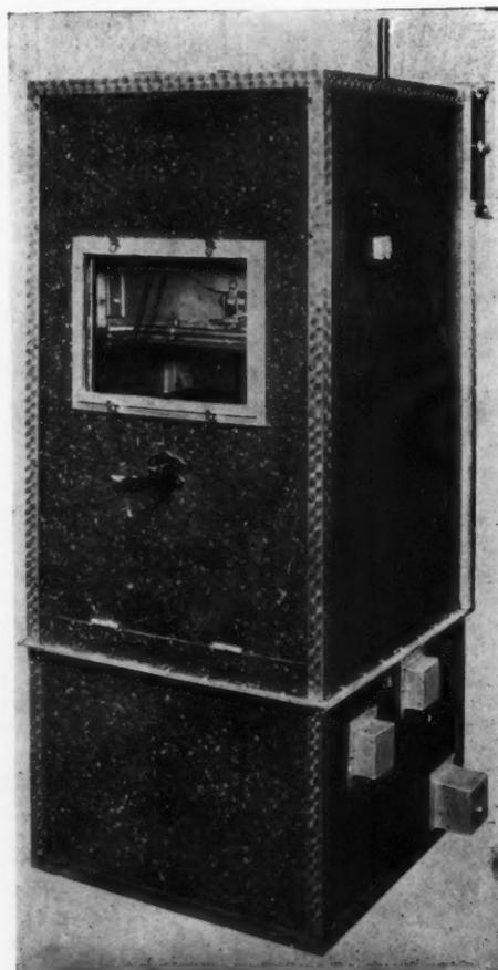
dant l'arrêt ou lorsque les besoins sont inférieurs à la production horaire. Ces petites machines du type haute pression « Monobloc » à compresseur rotatif au chlorure d'éthyle sont d'un parfait usage domestique.
