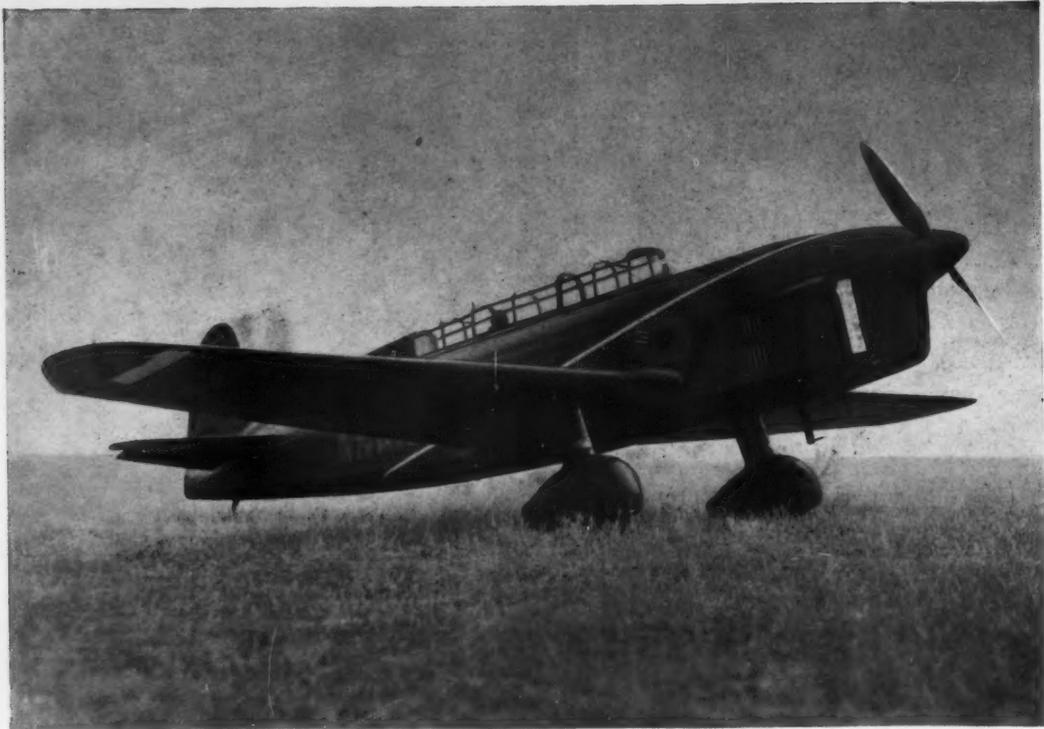
**LE RAFALE:** Caudron type C. 530, actionné par moteur Renault 140 C. V. Avion de tourisme: conduite intérieure, à dôme coulissant. Construction bois: âme contreplaqué bouleau, nervures à âmes pleines, revêtement en contreplaqué bouleau, enduit, poncé, peint et verni. Dimensions: 9,20 × 7,30 × 1,90. Poids total: 880 kgr. Vitesse maxima: 300 km.-h.; vitesse de croisière: 265 km. Rayon d'action: 1.300 km. Consommation: 35 litres-heure.
