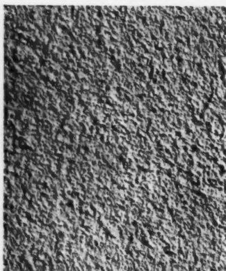
FIG. 17 et 18. — Texture obtenue par frottement avec une lame de métal dans toutes les directions.
