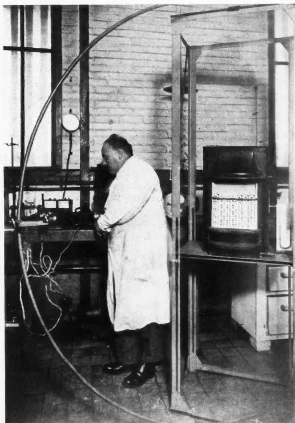
ESSAI D'UN RADIATEUR POUR L'ESTAMPILLAGE. MESURE DE LA CHALEUR RAYONNÉE
