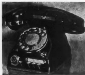
FIG. 2. INTERCOMMUNICATION 1 ligne 4 postes.
