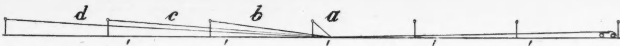
Fig. 4. Graphique montrant le rôle des sources de lumière éloignées pour la visibilité d'un objet: un obstacle situé en a est rendu visible par effet silhouette sur la tache lumineuse produite par les rayons d. Les rayons a, b et c sont moins efficaces.
