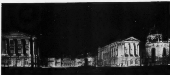
ECLAIRAGE DU CHATEAU DE VERSAILLES Eclairage par le bas, puissance 85 kw (lampes à incandescence).
