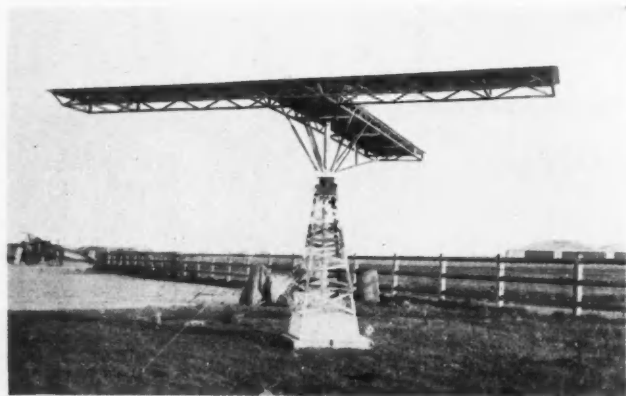
VUE DU TÉ D'ATERRISSAGE ASSERVI
