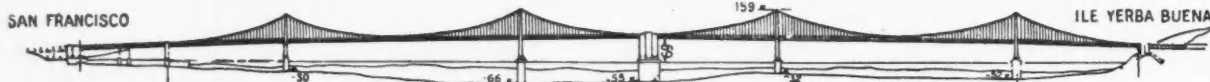
PONTS DE SAN-FRANCISCO A OAKLAND: Deux ponts suspendus relient la ville à l'île Yerba Buena (2.740 m.) traversée par un tunnel. De l'île à Oakland la route passe sur un pont cantilever de 156 + 427 + 156 m. et sur une série de ponts plus petits (longueur totale: 12 km.). Inauguré récemment. Bibliographie: l'Ossature Métallique, 1936, n° 6.
