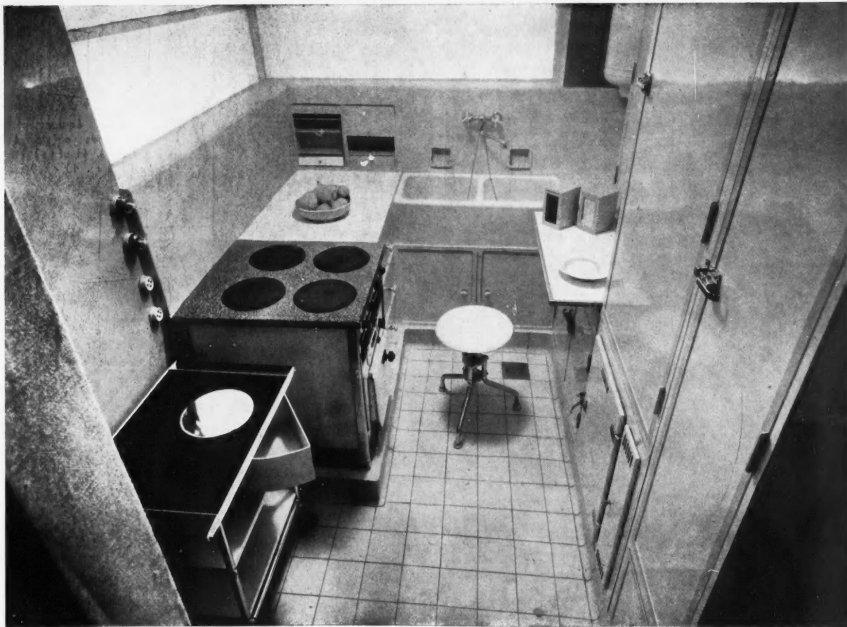
CUISINE-LABORATOIRE. Cette vue plongeante donne l'idée exacte de la chaîne d'appareils disposés tout autour des murs. La ménagère peut être assise sur un tabouret pivotant et effectuer selon le schéma d'organisation, les différentes besognes ménagères (préparation des aliments et lavage de la vaisselle). Les dimensions particulièrement réduites de cette cuisine sont rationnellement déterminées pour concentrer en un même point, les différents « moments » du travail, d'où absence de va-et-vient inutiles, etc...
