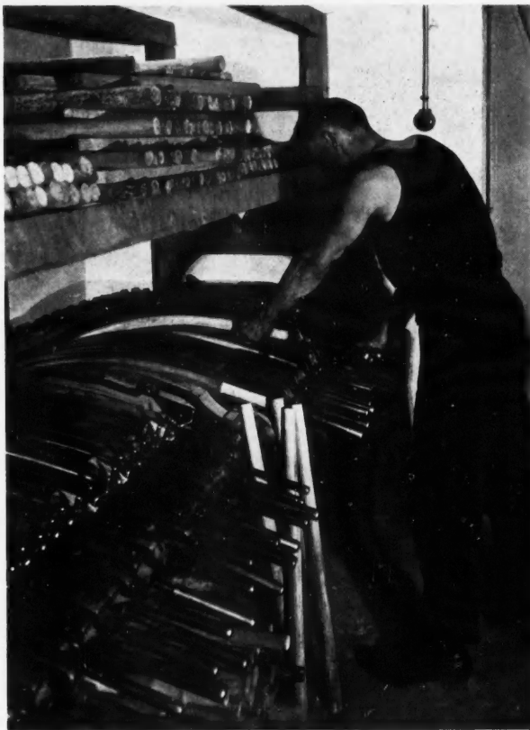
FIG. 2 - COURBURE A LA MAIN: LA VIS DE COMPRESSION EST SERRÉE EN MÊME TEMPS QUE S'EFFECTUE LA COURBURE
