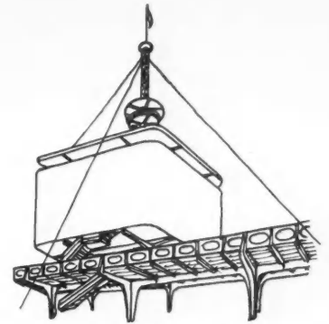
TCHÉCOSLOVAQUIE. Ossature concentrée sur quatre points. Parois supportées par des consoles, toiture détachée.
