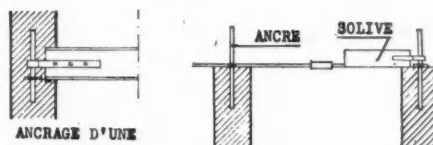
ANCRAGE D'UNE SOLIVE EN FER
