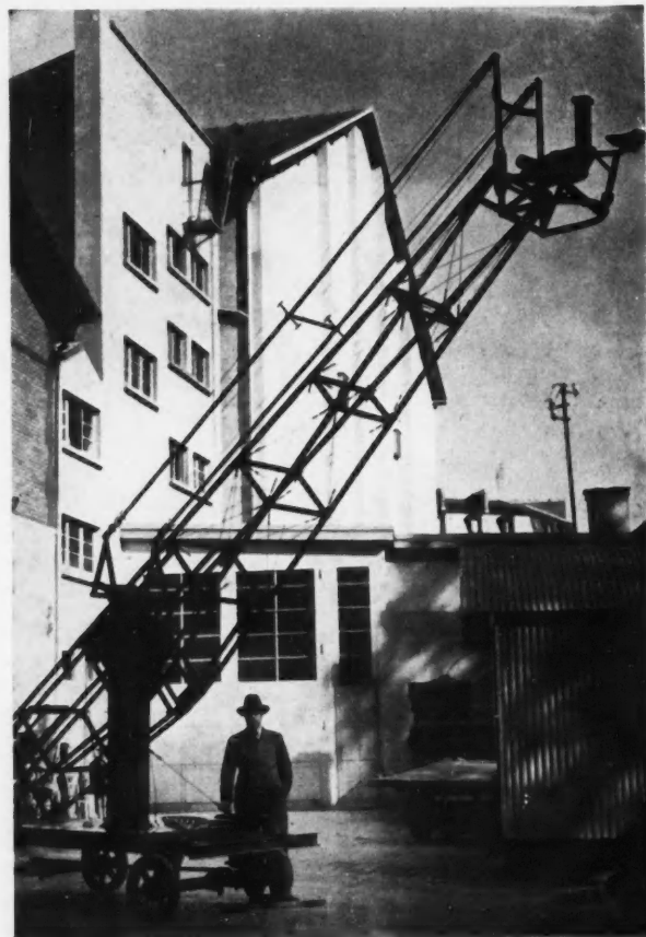
GRUE POUR PRISES DE VUES: levée: 7 mètres.
