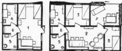
A gauche, plan d'une maison de 5 panneaux. A droite, la même maison agrandie à 9 panneaux.
