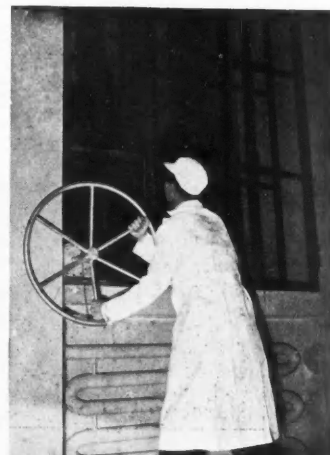
MANŒUVRE DES VOLETS
