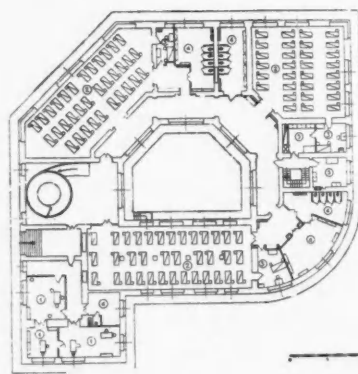
PAVILLON SUPERIEUR. De gauche à droite : demi sous-sol (1. Attente — 2. Infirmerie — 3. Vestiaire — 4. Douches — 5. Bains — 6. Magasins — 7 à 10. Buanderie et Lingerie). Rez-de-chaussée: (1. Bureau — 2. Dortoir — 3. Surveillant — 4. Toilettes — 5. Services). Etage: (même disposition).
