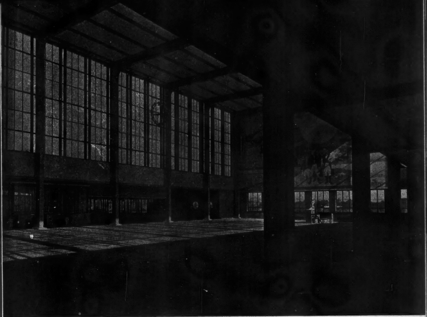
LE GRAND HALL : PORTIQUES EN ACIER SOUDES LAISSES APPARENTS.
