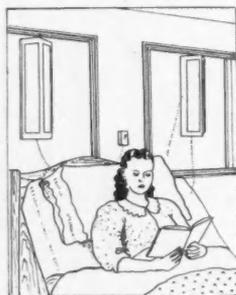
FIG. D. — Eclairage de chevet par allumage des deux panneaux médians et éclairage général par éclairage des deux panneaux extrêmes. (Chambre privée à la Maternité du Salem Hospital, U.S.A.)
