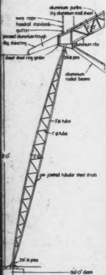
1. Le dôme en cours de construction ; 2. Axométrie coupe et plan du bâtiment ; 3. Détail d'un pylone de support montrant l'articulation à cheville permettant l'extension ou la contraction du dôme d'aluminium.
