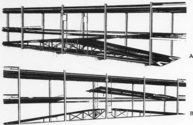
FONCTIONNEMENT DE LA RAMPE. A. Rampe en position de circulation entre deux niveaux. B. Entre les deux circulations d'un même niveau (voir photo ci-dessus). Manœuvre par contre-poids.
