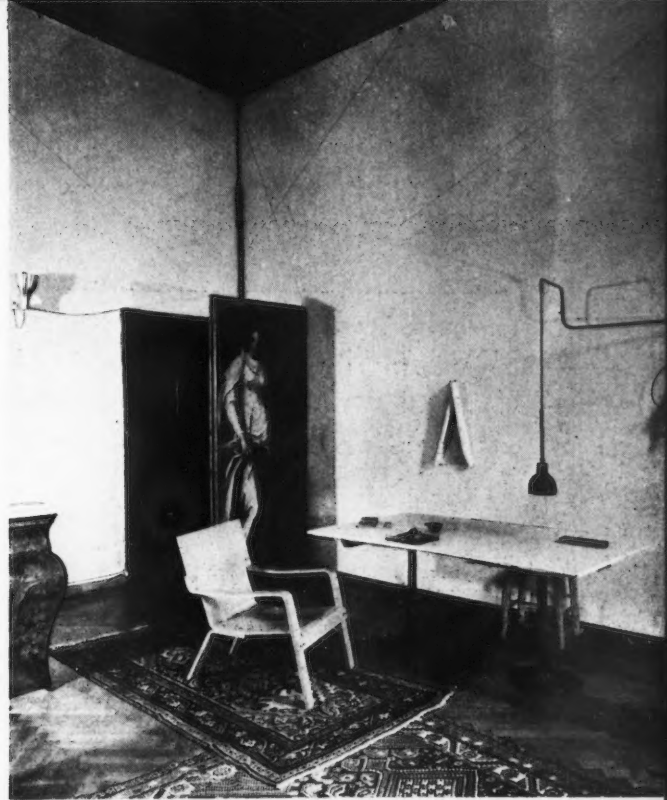
Chaise en contre-plaqué courbé, montage sans colle, joints cloués en laiton, dossier oscillant sur coussinets de caoutchouc.
