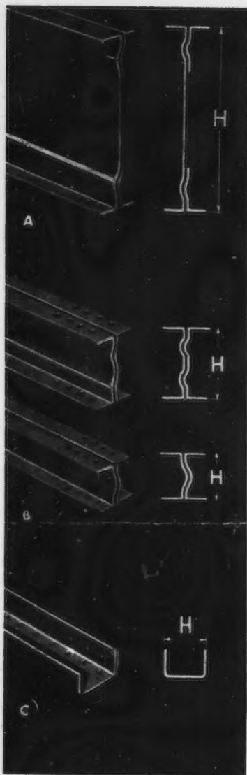
Profil A utilisé principalement comme solive. Profil B comme poteaux panne ou chevrons. Profil C comme semelles ou sablières.
