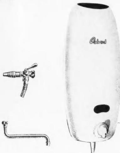
Ce chauffe-eau instantané à gaz est d'une utilisation extrêmement simple : un seul bouton avec aiguille indicatrice se déplaçant sur un cadran, permet d'obtenir immédiatement l'eau à la température voulue. Il peut être utilisé avec brise-jet normal, bec verseur orientable ou brise-jet flexible pour douche de deux longueurs : 15 et 25 cm.
