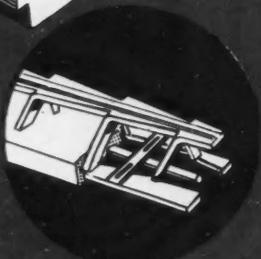
Profile en acier profilé, socle préfabriqué en béton, livrable aux longueurs désirées.
