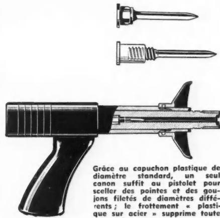
Grâce au capuchon plastique de diamètre standard, un seul canon suffit au pistolet pour sceller des pointes et des goujons filetés de diamètres différents ; le frottement « plastique sur acier » supprime toute usure du canon.
