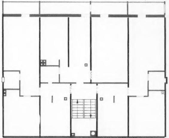
B. Plan d'un étage courant avec, en couleur, les éléments de béton préfabriqués, en noir la structure porteuse.
