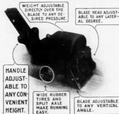
WEIGHT ADJUSTABLE DIRECTLY OVER THE BLADE TO ANY DESIRED PRESSURE.
