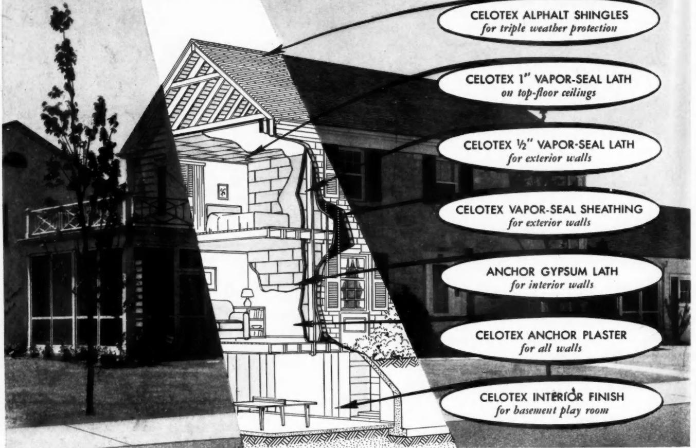
CELOTEX ASPHALT SHINGLES
