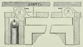
THE "QUEEN" MULLION FRAME PULLEY (ONE WEIGHT BALANCES THE SASH). THIS CUT SHOWS A  $2\frac{1}{2}$  IN. PULLEY.
