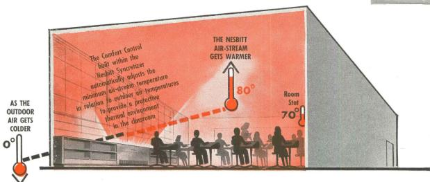
MINIMUM AIR DISCHARGE TEMPERATURE FOR VARIOUS OUTDOOR TEMPERATURES
