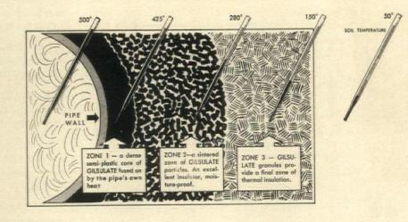
THE TRIPLE-ZONE INSULATION FOR LIFETIME PROTECTION OF HOT UNDERGROUND PIPES
