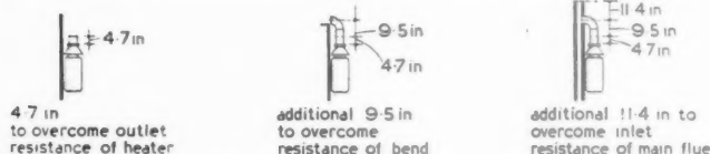
A. 90° BEND. 5' FLUE PIPE
