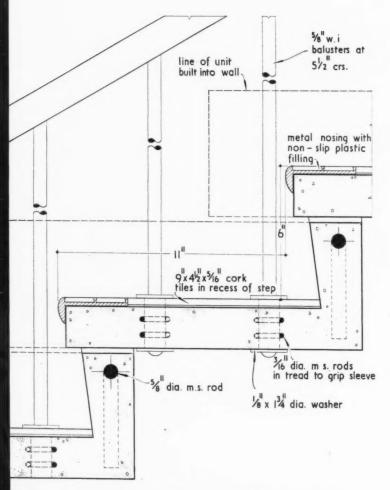
LONGITUDINAL SECTION THROUGH STAIRCASE.
