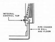
Fig. 17 (d). Floor box and double connector cock.
