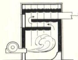
OIL BURNING SECTIONAL CAST-IRON BOILER
