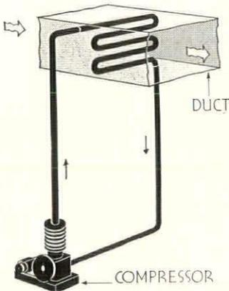
COOLING WITH MECHANICAL REFRIGERATION
