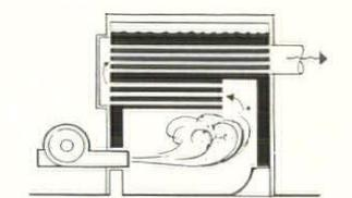
OIL BURNING HORIZONTAL TUBULAR BOILER
