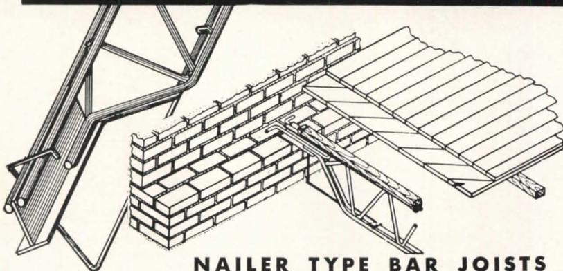
**NAILER TYPE BAR JOISTS**
