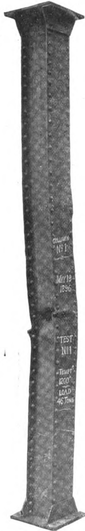
Fig. 2.—Steel Column.—Load 46 Tons, Temp. 1200°.
