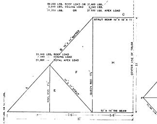
Fig. 2 .- Truss Diagram .- Scale, 3-16 In. to the Foot.
