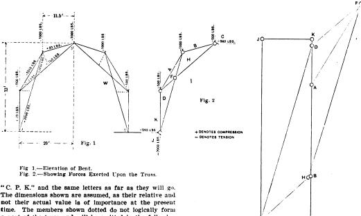
Fig. 3.-The Stress Diagram
