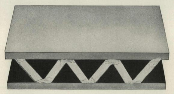
2. THE MOST VERSATILE ALL-GYPSUM STUD PARTITION FOR A LIGHT-WEIGHT HOLLOW WALL!
