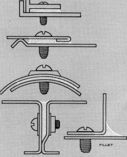
FIGURE IO. TYPICAL NON-WORKING JOINTS
