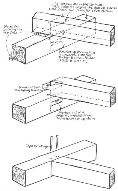
SCRIBING SEQUENCE (THE PROCESS OF MARKING OUT THE JOINTS FOR CUTTING)
