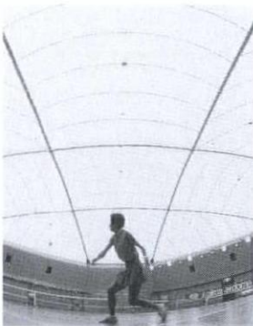
クリエイティブ・テニスガーデン千葉(エアドーム) 膜屋根を空気で支えるため超大スパンにも対応が可能、戸外のような明るい大空間。
