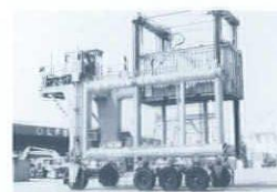
12: 小型トランスファ・クレーン 1: 横浜市中区本牧埠頭D突堤 3: 高さ10m
