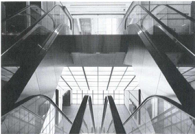
地下1階コンコースより1階へ向かう。1階の光床と地下1階の光天井、光壁の関係が理解できる空間
