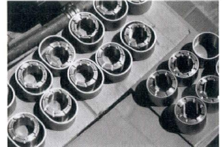
右側が、ガラス梁ユニットを結合させるベゼルと呼ばれる金物。外環に対し内環の軸を偏心させ、回転させることで横に重ねられたガラスどうしの軸芯を合わせる。左側はアクリル梁のベゼル金物。通常時は力がかからないように大きな遊びが設けられている
