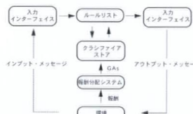
クラシファイア・システムの概要図
