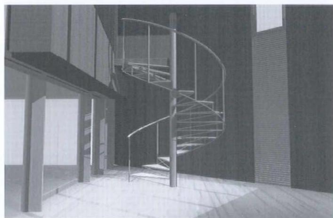
全てスチールロッド16φで構成される螺旋階段でロッドの径を変えて検討をしている
