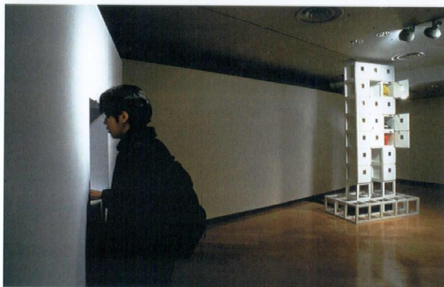
会場に置かれた、ヴァーチャルな部屋の模型。18個の扉の付いた正方形の箱が、積み重なっている。参加者が入り込んでいる部屋の扉が開くようになっている。この模型でそれぞれ隣り合っている部屋へのみ移動することが可能。扉は空気圧によってコントロールされている
