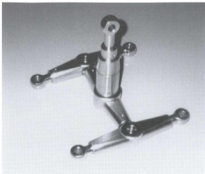
ピーター・ライスとの共同開発によるH型ホルダー。性能は200kg/m 2 から600kg/m 2 にアップし、ターンバックル機構も上下、左右に加え、前後調整が可能となった。しかし全形は海外のものに比べ、ずんぐり型となった。 資料提供：旭硝子ビル建材エンジニアリング(株)
