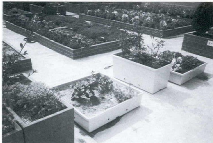
鹿島技術研究所での人工軽量土壌の生育試験
