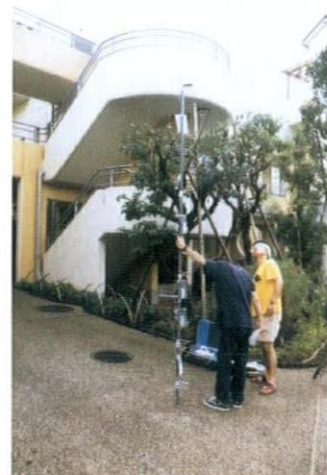
断面温度分布の測定風景。高さ3mの棒に温湿度センサーを取り付けて測定した
