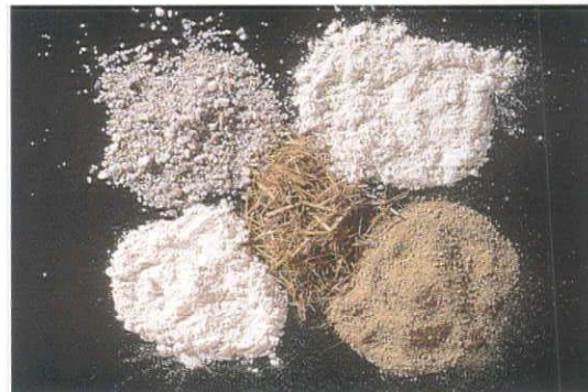
ソイルセラミックスの原料。ワラ、スサ、貝殻などの添加も可能
