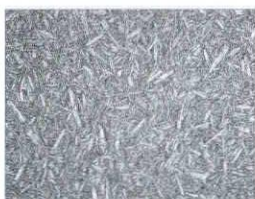
建築廃材の木チップを利用した舗装材
