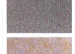
アルセライト:アルミとガラスのリサイクル品を利用した複合材
