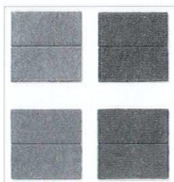
下水道汚泥焼却灰を利用した舗装用煉瓦
