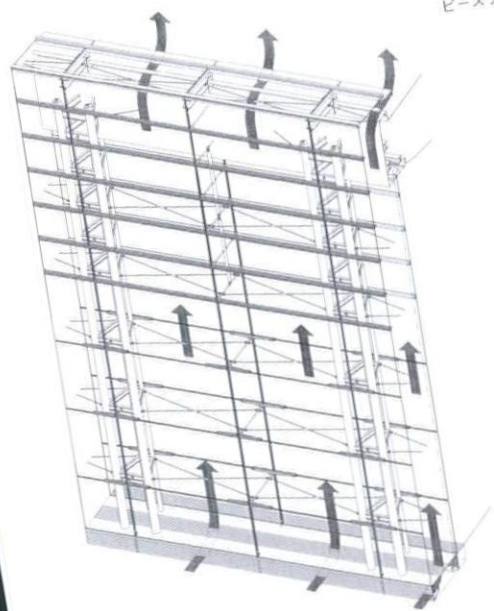
ダブルスキン構成図。気流の流れを示す
