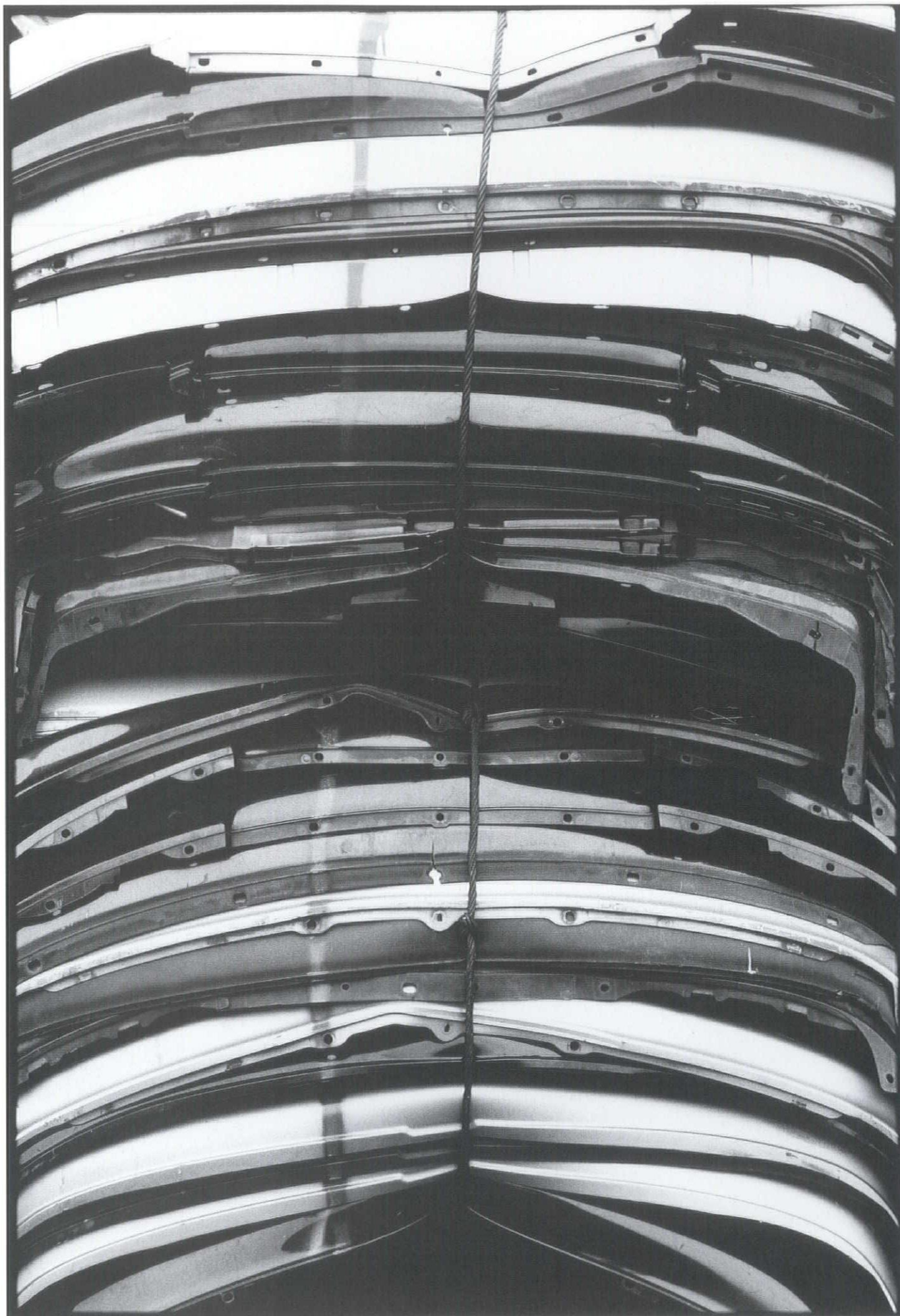
不純物質を取り除かれて、材料リサイクル工場へ出荷される回収バンパー。この後、粉碎、再ペレット化の工程へと移る。
