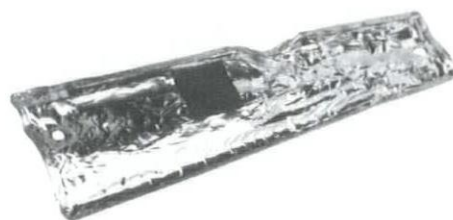
前のタイプのエキゾーストパイプの遮熱材。ミネラルウールが入っていたために、リサイクルしにくかった。
