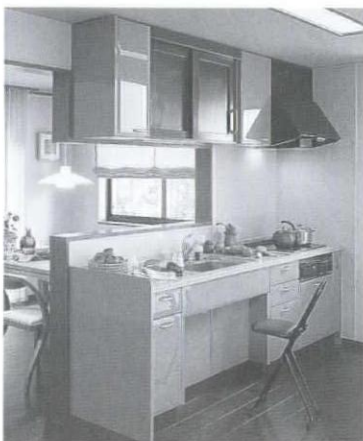
高齢者にも作業しやすく、安全性にも配慮。離れた場所から、操作できるリモコン付きレンジフード。火を使わないから安全なIHヒーター。座って作業ができるニースペースキッチン。(大建工業「NEW ダイノールレビュー」INタイプ)
