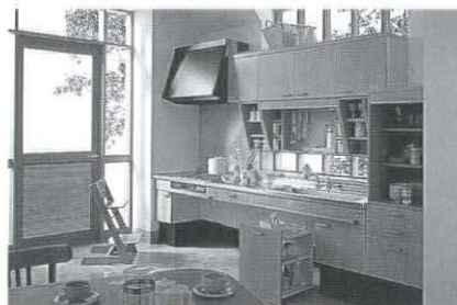
長時間の立ち仕事負担になる高齢者に使いやすいキッチンとして開発。カウンターの高さは73～85cmの13種類、1cmきざみで調整できる。椅子に座ったままでも料理ができるキッチン。配膳にはワゴンが便利。(サンウエーブ工業「ウエル ライフ キッチン」住宅金融公庫割増融資「高齢者等対応設備設置工事」対応機種)
