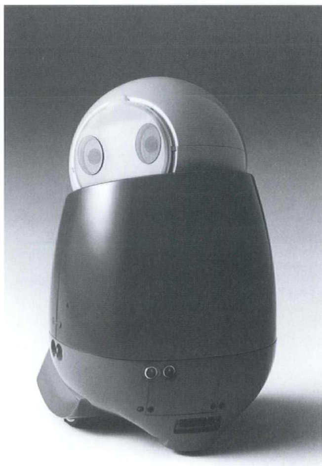
視覚センサーにより、画像を認識しているR100。人の顔を記憶して、相手に応じた反応を返すことが可能
