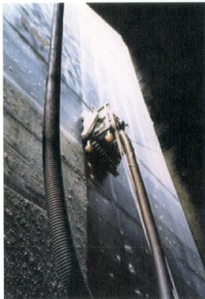
海上石油備蓄船にとりついている真空吸着自走式研磨ロボット ／浦上技術研究所
